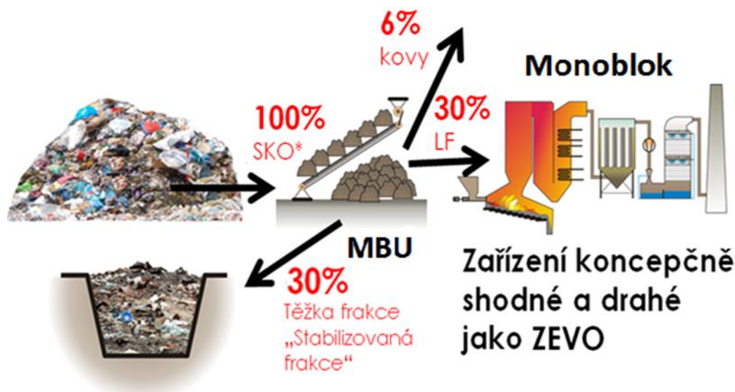
Obr. 23 Příklad – schéma možných materiálových toků při produkci paliva z odpadů v MBÚ a jeho spalování ve specializovaném monobloku
